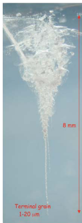
Fig 1 : Trace #41 cellule Aérogel C2044. Les échantillons analysés dans cette étude ont été extraits de la paroi de la cavité. La trace triangulaire laissée par l'outil de prélèvement est visible dans le coin supérieur gauche.
