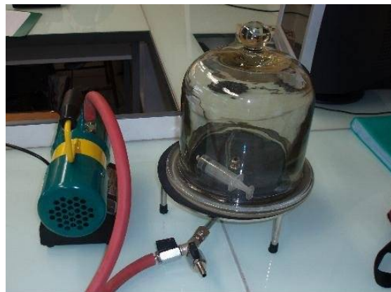
Etalonnage d'une seringue avec une cloche à vide
