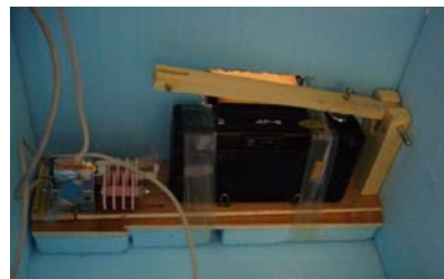
Exemple de système mécanique déclenchant un appareil photo
