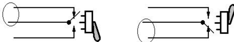
Exemple d'interrupteur : l'inverseur simple = toujours une partie "ouverte" et une partie "fermée" (le partie fermée est entourée)
