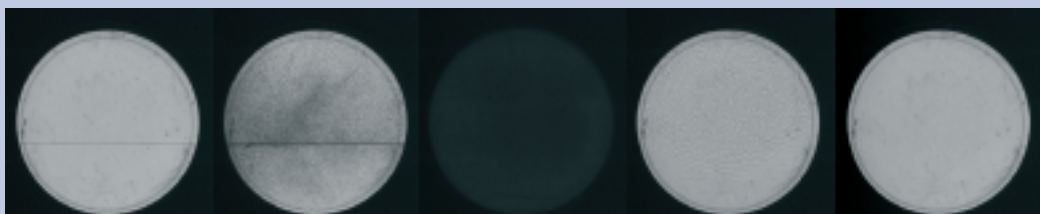
Passage d'un état supercritique monophasique (2 images de gauche) à un état liquide-vapeur (2 images de droite), présence d'une interface.
