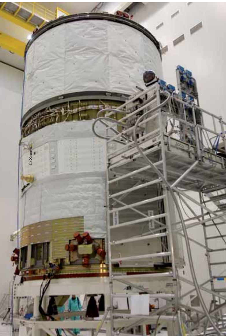
Remplissage de l'ATV Jules Verne en ergol UDMH pour ravitailler le module de service russe Zvezda de l'ISS
