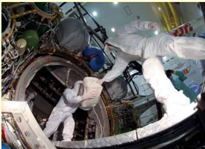
Chargement du cargo sec à destination des astronautes de l'ISS dans le module pressurisé de l'ATV
