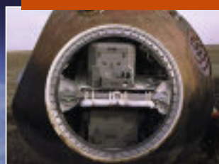
Capsule récupérable Photon contenant l'instrument de biologie IBIS du CNES.
