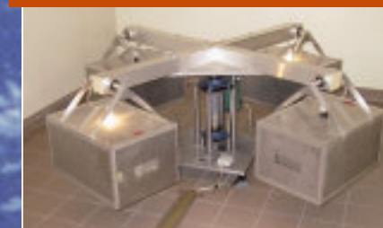
Centrifugeuse utilisée pour des expériences d'hyper gravité.
