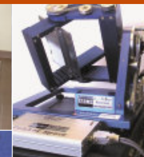
Clinostat 3D permettant d'orienter aléatoirement des échantillons par rapport à la gravité.
