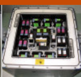
L'instrument KUBIK et un exemple de cassette expérimentale. Ils sont utilisés à bord du vaisseau Soyuz et de l'ISS.
